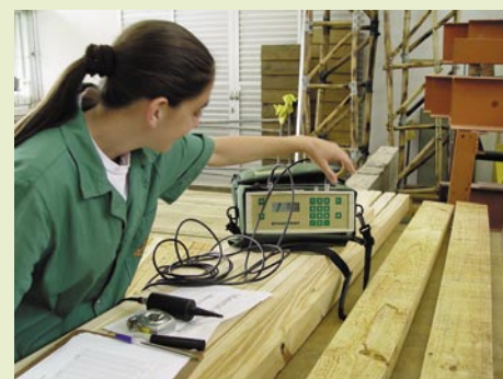
Utilização do aparelho de ultra-som para obter a velocidade da onda sonora nas peças de madeira
