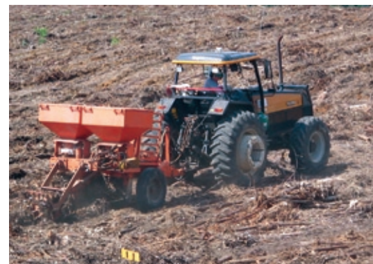
Subsolador utilizado na Suzano para a adubação em taxa fixa através da controladora de vazão
