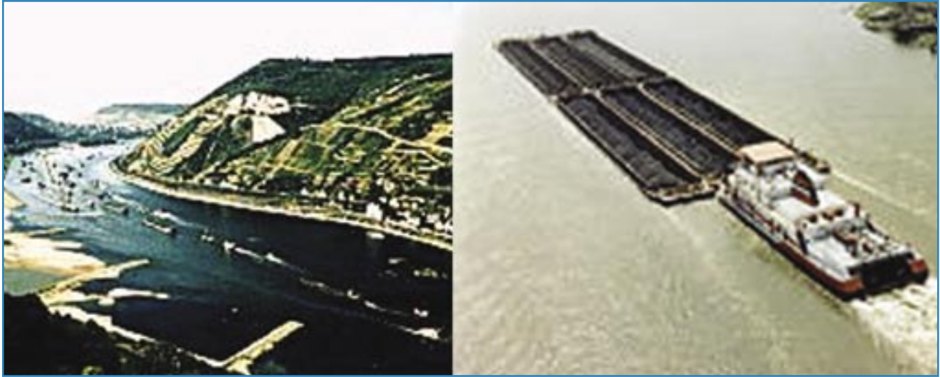
Foto 2 - Tráfego no rio Reno e moderno comboio de empurra no rio Waal. Dimensões do comboio: 189 m (comprimento), 22,8 m (boca) e 3,5 m (calado)
