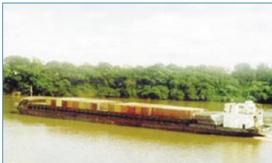
Foto 31 - Autopropelido com Contêineres
