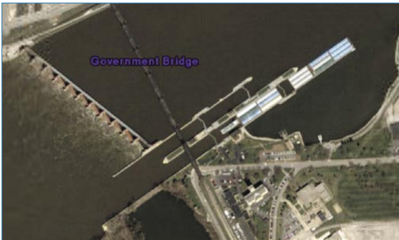
Foto 9 - Eclusa de Davemport – alto rio Mississippi com conjunto de duas eclusas em paralelo
