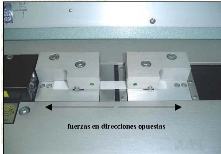
FIG.9 Fotografía de un medidor de tensión, describiendo un ensayo para determinar el Índice de tensión de una muestra de celulosa refinada. (Fuente: Manual de Productos de Planta Arauco, 2009)
