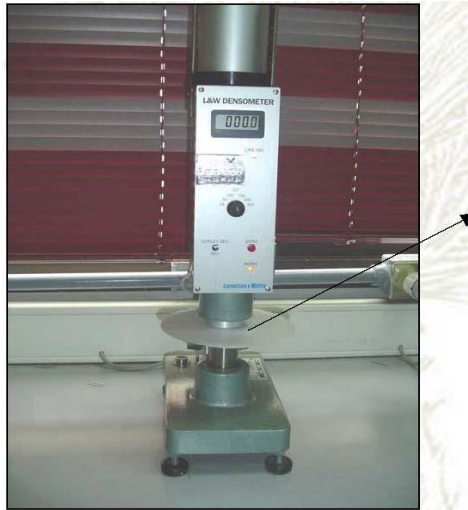
FIG.12 Fotografía de un medidor de resistencia al aire gurley (porosidad), describiendo un ensayo para determinar la porosidad gurley de una muestra de celulosa refinada al cual se le está pasando un flujo de 100 ml de aire. (Fuente: Manual de Productos de Planta Arauco, 2009)
