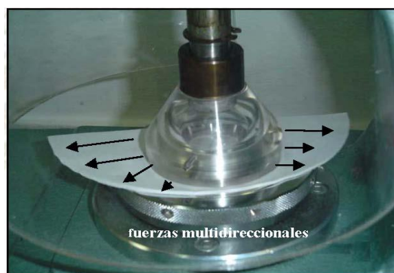
FIG.10 Fotografía de un medidor de explosión, describiendo un ensayo para determinar el índice de explosión de una muestra de celulosa refinada. (Fuente: Manual de Productos de Planta Arauco, 2009).
