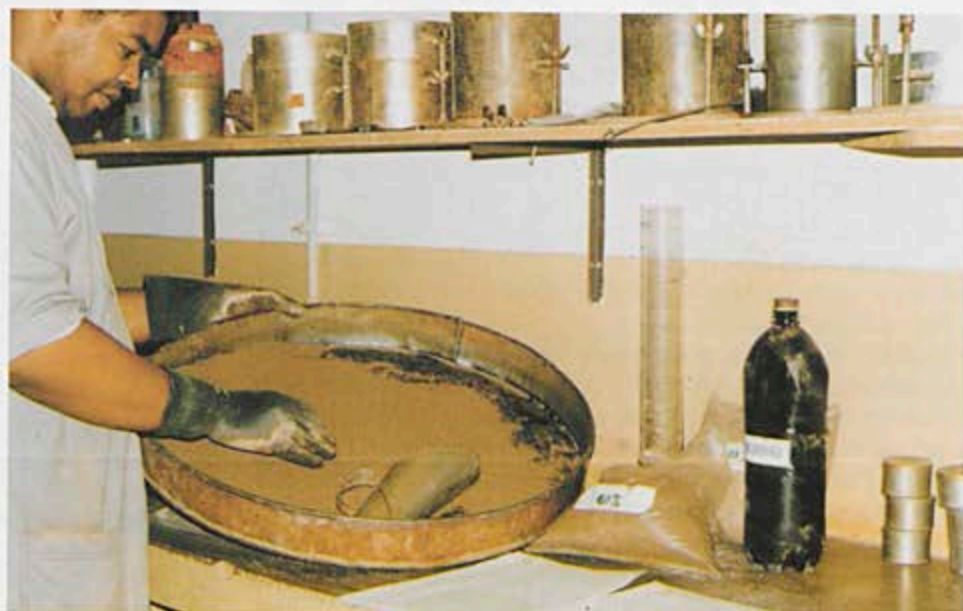
Testes de laboratório do produto feito a partir de alcatrão para ser usado como estabilizante de solos em estradas florestais.
