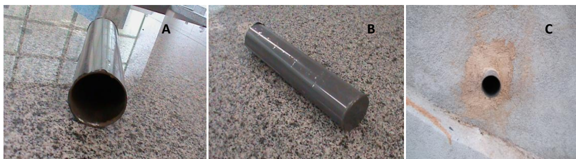
Figura 4 – (A) Vista da extremidade aberta do cilindro metálico; (B) Vista da lateral e da extremidade fechada do cilindro metálico; (C) Vista externa do cilindro metálico instalado na parede do forno.
