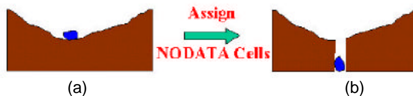
Figura 18 – Vista transversal de uma depressão natural (sumidouro) de um MDE (a) e o assinalamento de célula NODATA para representação computacional (b).
