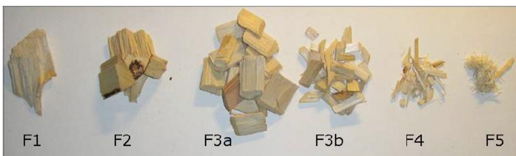
Figura. 9, resultado de un clasificador de astillas usando la norma SCAN-CM 40:01; F1 sobre tamaño, F2 sobre espesor, F3a aceptado 1, F3b aceptado 2, F4 Pinchip, F5 finos.
