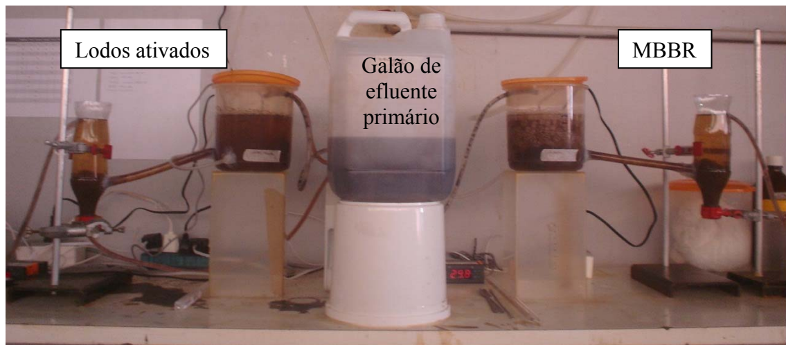
Figura 5 - Configuração dos reatores em bancada, operando em paralelo.
