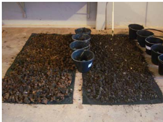
Figura 2.10 – Lodo disposto sobre lona plástica para secagem adicional e quebra prévias à moagem.
