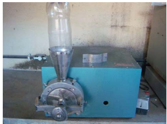
Figura 2.11 – Moinho utilizado para reduzir a granulometria do lodo
