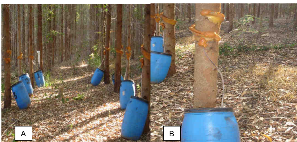
Figura 11- A: Coletores arbóreos utilizados para quantificar o escoamento pelo tronco. B: Detalhe do coletor arbóreo, Bacia Hidrográfica do Riacho Fundo, Felixlândia – MG, 2008.
