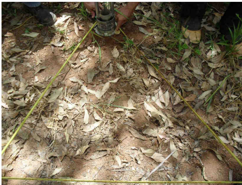
Figura 14- Forma de triângulo para determinação da velocidade de infiltração básica na Bacia Hidrográfica do Riacho Fundo, Felixlândia-MG. Fevereiro, 2011.
