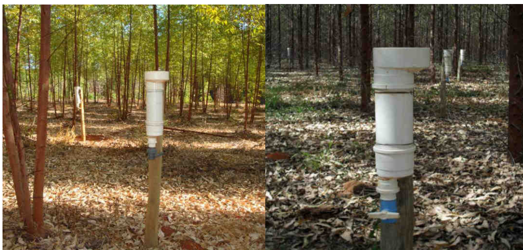
Figura 10- Pluviômetro para quantificar a precipitação interna, Bacia Hidrográfica do Riacho Fundo, Felixlândia – MG, 2010.
