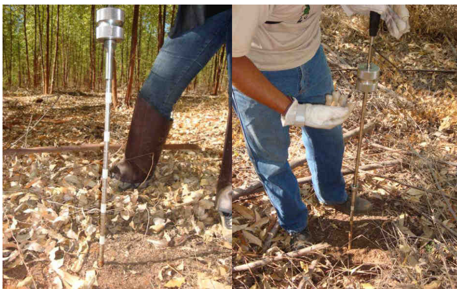
Figura 15- Penetrômetro de impacto para determinação da resistência mecânica do solo na Bacia Hidrográfica do Riacho Fundo, Felixlândia-MG, fevereiro, 2011.
