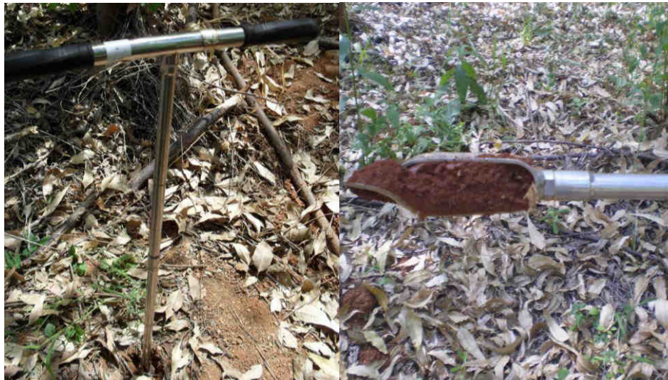
Figura 16- Uso do trado para coleta de amostras de solo, na Bacia Hidrográfica do Riacho Fundo, Felixlândia-MG, fevereiro, 2011.
