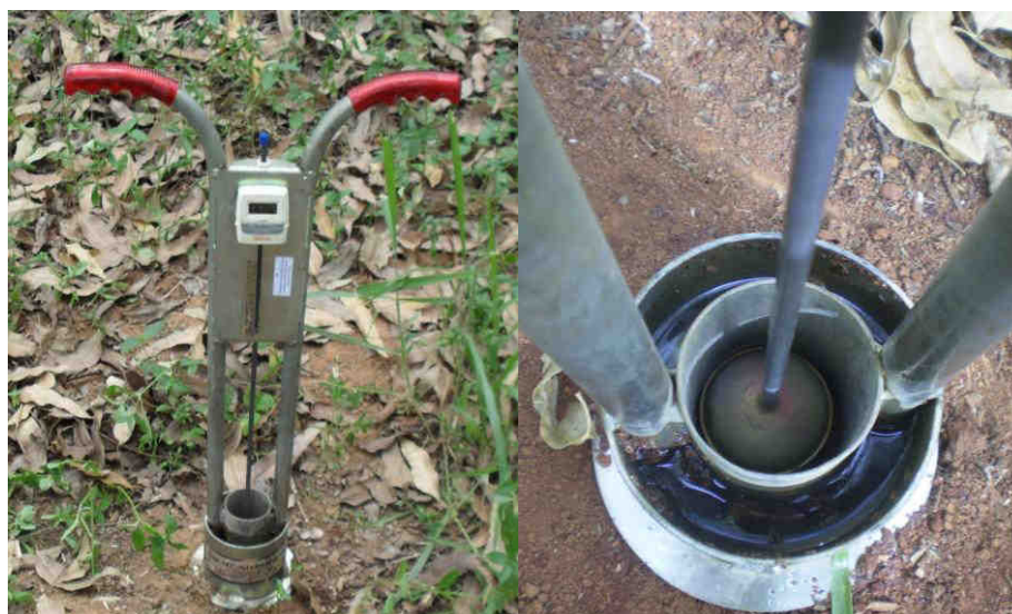
Figura 13- Infiltrômetro de anéis concêntricos para determinação da infiltração de água no solo na Bacia Hidrográfica do Riacho Fundo, Felixlândia-MG. Fevereiro, 2011.
