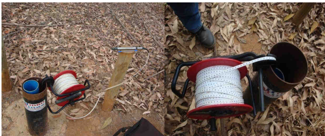
Figura 18- Poço piezométrico para avaliação do nível do lençol freático, Felixlândia- MG, 2010.
