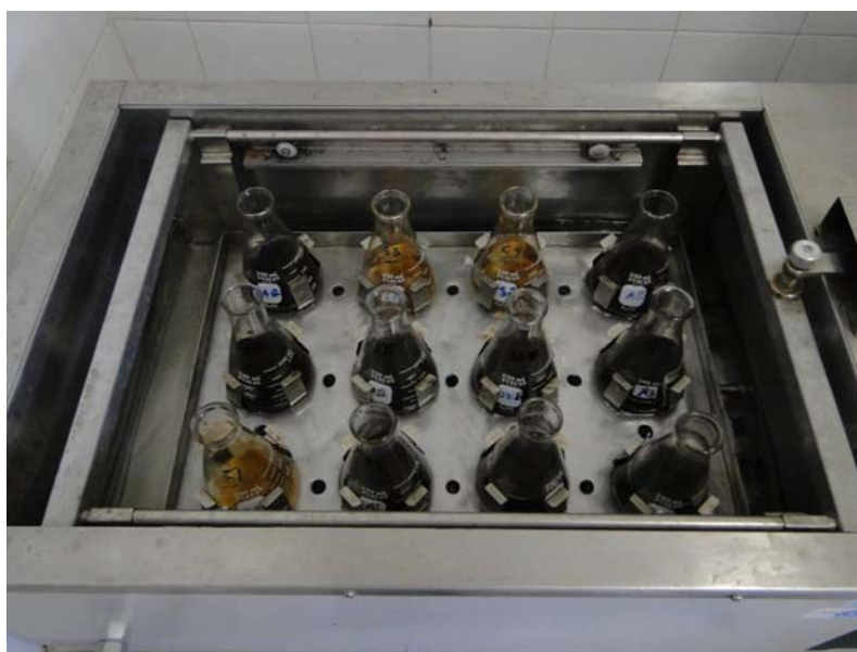
Figura 10 – Visualização da montagem do experimento em banho-maria com mesa agitadora, para avaliar os mecanismos de remoção da matéria orgânica.
