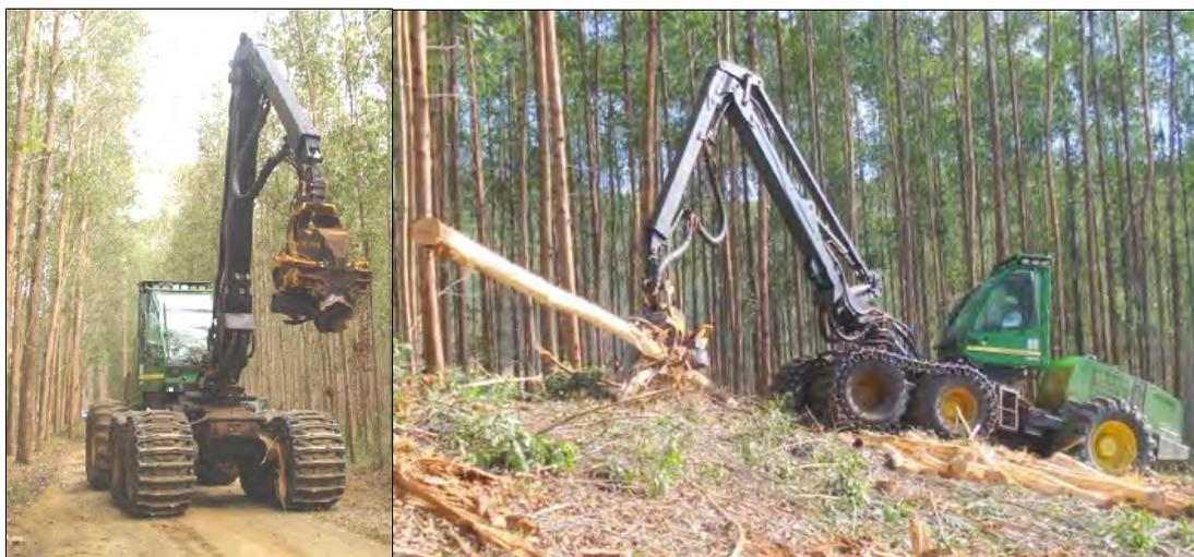
Figura 2.4 – Vistas frontal e lateral do *Harvester* John Deere, modelo 1470D.
