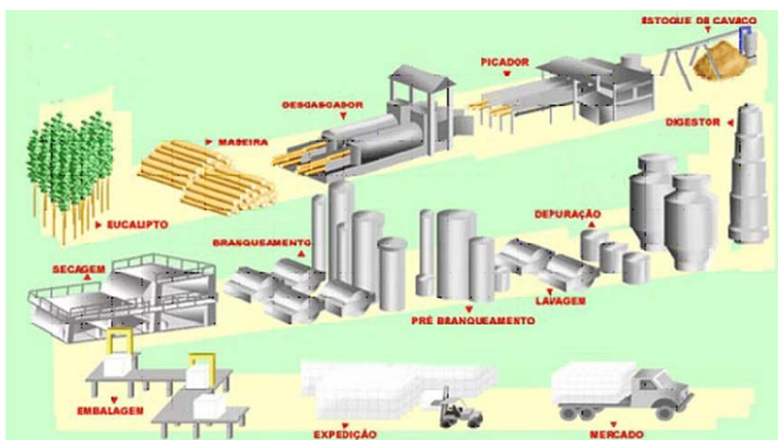
Figura 1: Etapas do processo de produção de celulose.
