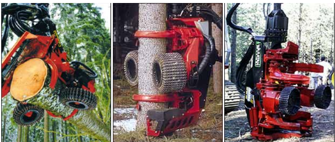
Figura 5 – Detalhes do cabeçote do “Harvester”.
