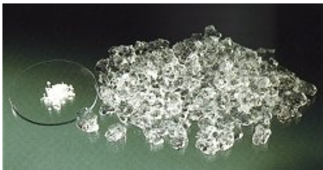
Figura 1 – Polímero hidrorretentor, seco e hidratado. Fonte: < www.stockosorb.com >.
