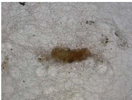
Figura 4.22 – Microfotografia de contraste de fase de uma amostra fresca do lodo biológico, evidenciando a concentração excessiva de bactérias filamentosas, durante a Fase 2 deste experimento (100x).
