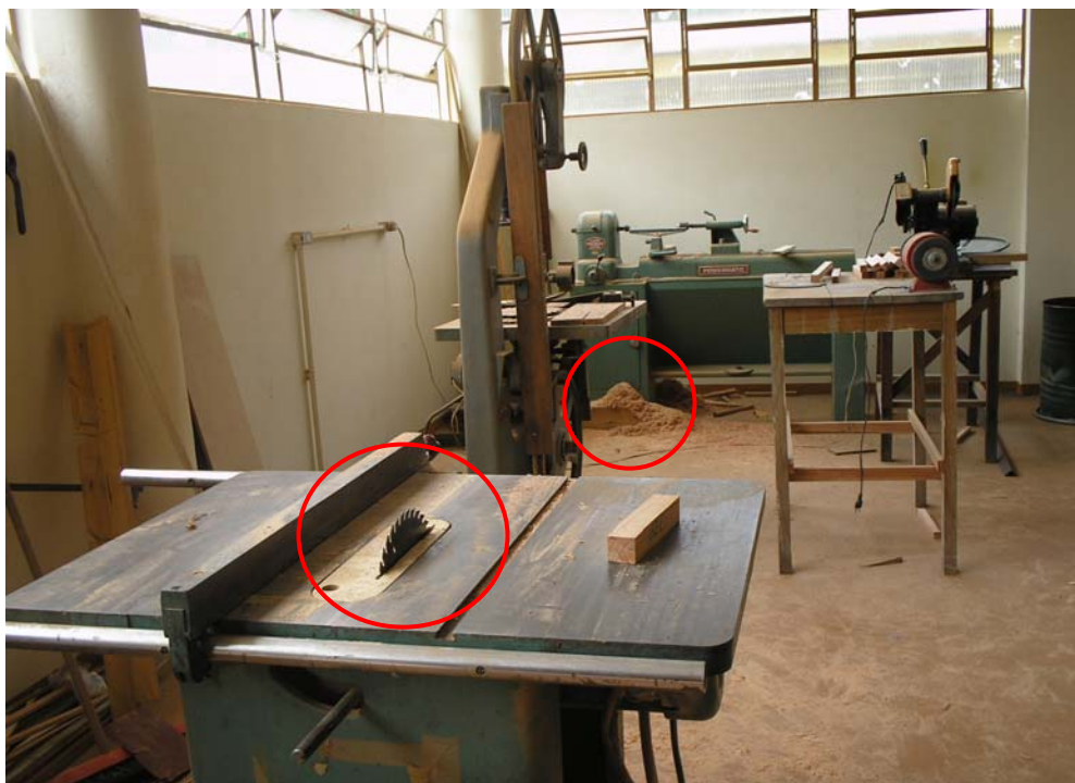
Figura 24 – Serra circular sem proteção e acúmulo de serragem (Marcenaria para preparo de corpo de provas e preparo de aulas práticas)
