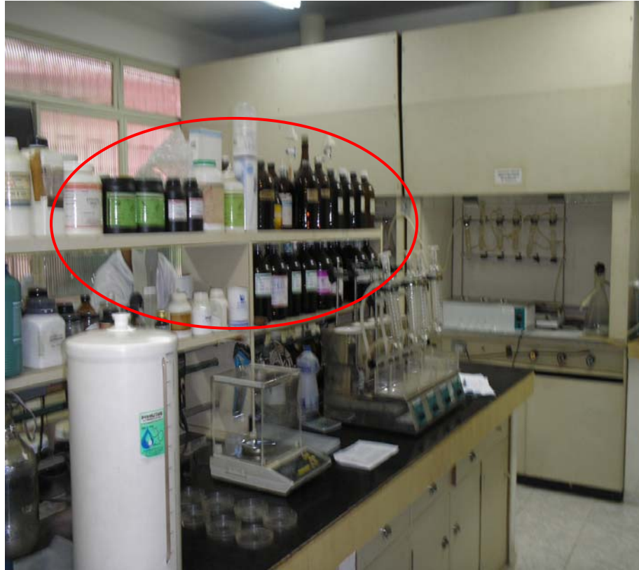
Figura 30 – Bancada sem guarda-corpo para os reagentes químicos
