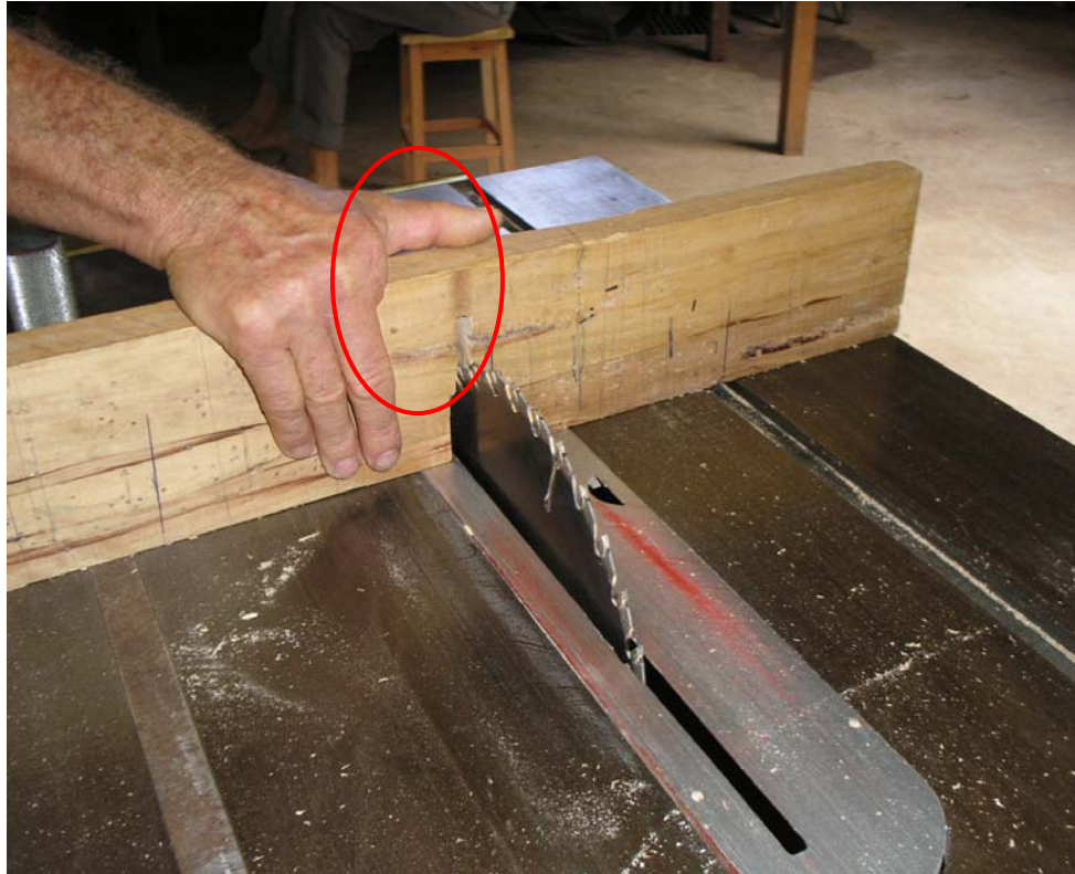
Figura 28 – Dano físico provocado pela falta de proteção da serra circular
