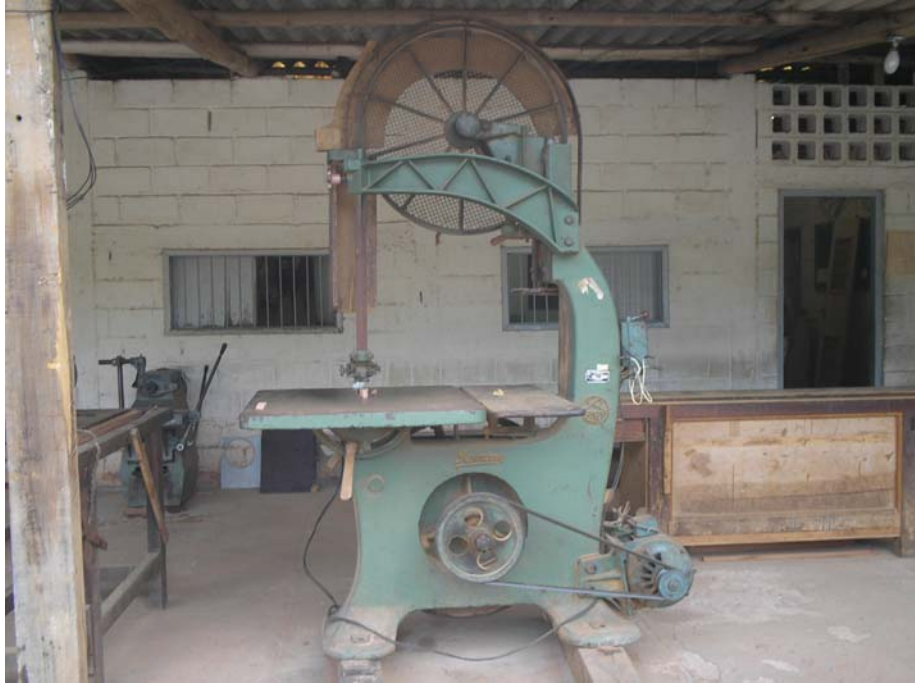
Figura 17 – Máquina serra de fita com as partes girantes desprotegidas
