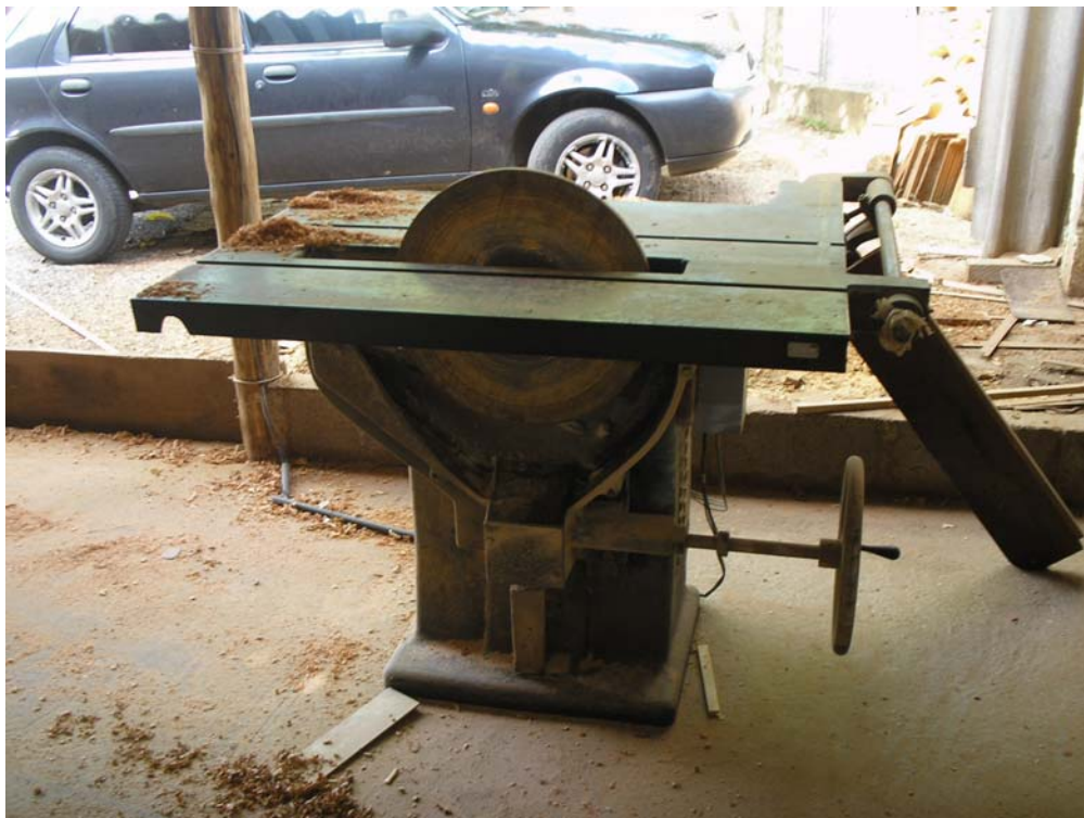
Figura 19 – Serra circular de bancada adaptada como lixadeira
