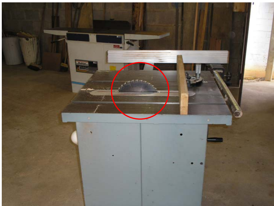
Figura 27 – Serra circular em condições de risco
