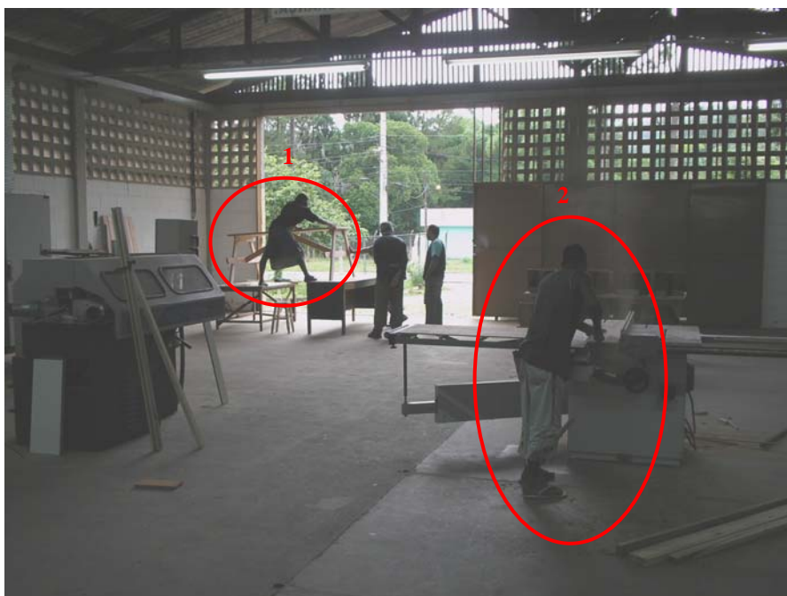
Figura 22 – Risco ergonômico e de acidente (1) e ausência de EPI (2)
