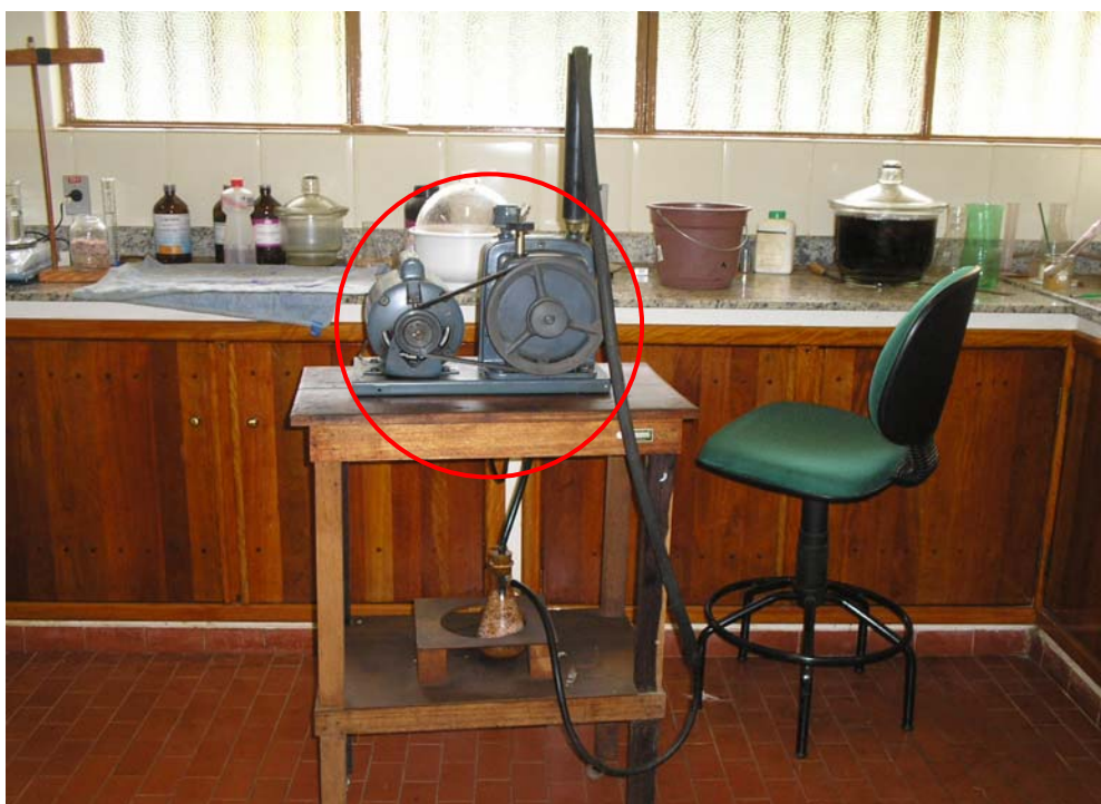
Figura 25 – Bomba de vácuo com partes girantes sem proteção (Laboratório de Ensaios Físicos e Extrativos da Madeira)
