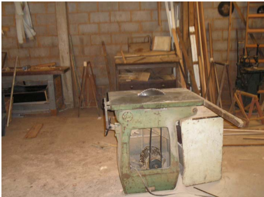
Figura 18 – Serra circular de bancada sem coifa protetora
