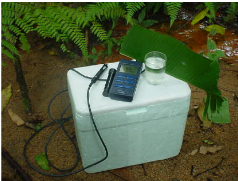
Figura 7 – Oxímetro utilizado para determinações de oxigênio dissolvido e temperatura da água em condições de campo.
