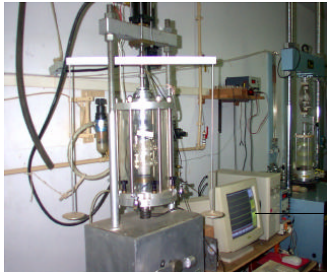
Figura 10 - Equipamento triaxial cíclico empregado: câmara triaxial com amostra no seu interior, assentada na base, célula de carga e válvulas solenóides.
