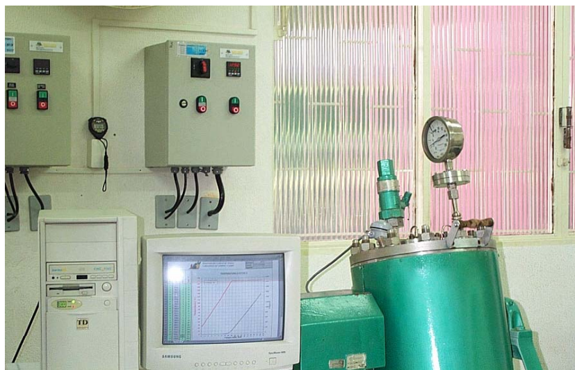
Figura 12: Digestor batch computadorizado com seus quatro reatores.
