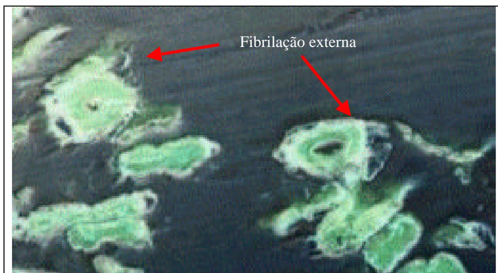
Figura 12- Corte transversal do papel ultrasonificado a 3% consistência por 60 minutos.
