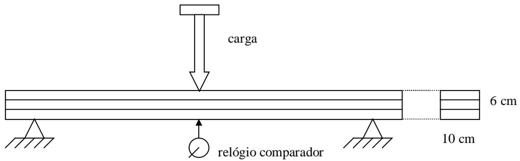
Figura 19 - Ensaio de flexão estática dos elementos estruturais.
