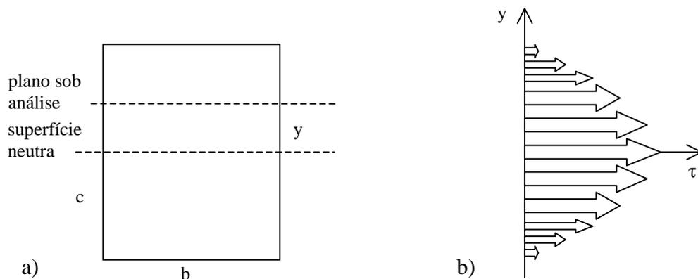
Figura 3 - Distribuição das tensões cisalhantes no perfil de uma viga sob flexão. a) corte transversal de uma viga de largura  $b$  e altura  $h = 2c$ , mostrando a superfície neutra e um plano qualquer a ela paralelo; b) distribuição das tensões de cisalhamento ( $\tau$ ) em função da posição  $y$ .
