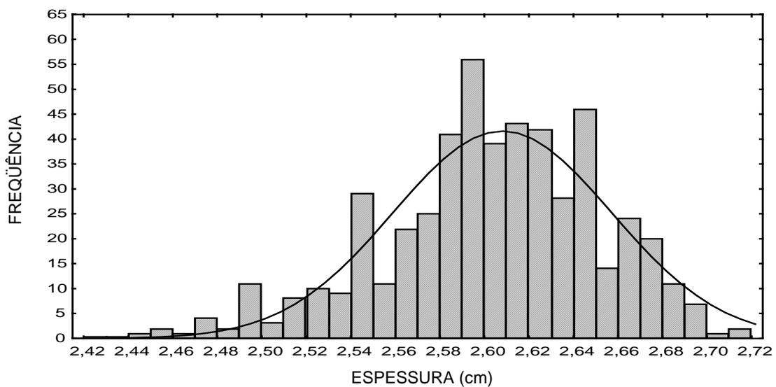
Figura 5 - Distribuição de frequência das espessuras das tábuas.
