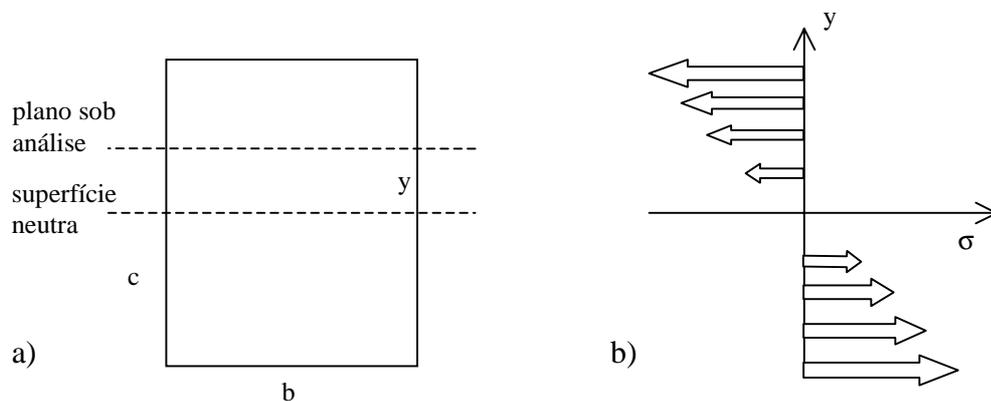
Figura 2 - Distribuição das tensões normais no perfil de uma viga sob flexão. a) corte transversal de uma viga de largura  $b$  e altura  $h=2c$ , mostrando a superfície neutra e um plano qualquer a ela paralelo; b) distribuição das tensões de flexão ( $\sigma$ ) em função da posição  $y$ .
