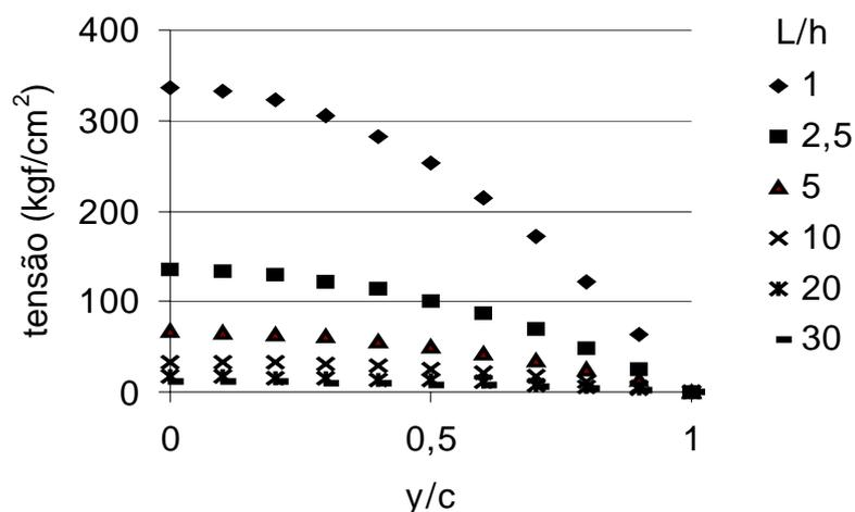
Figura 4 - Variação das tensões de cisalhamento no perfil de vigas com diferentes relações L/h, todas submetidas à tensão de flexão de 673 kgf/cm<sup>2</sup>.
