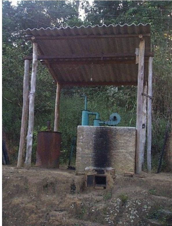
Figura 1 - Primeiro forno container desenvolvido. (SILVA, 1988 -Laboratório de Painéis e Energia da Madeira da Universidade Federal de Viçosa - Viçosa - MG)
