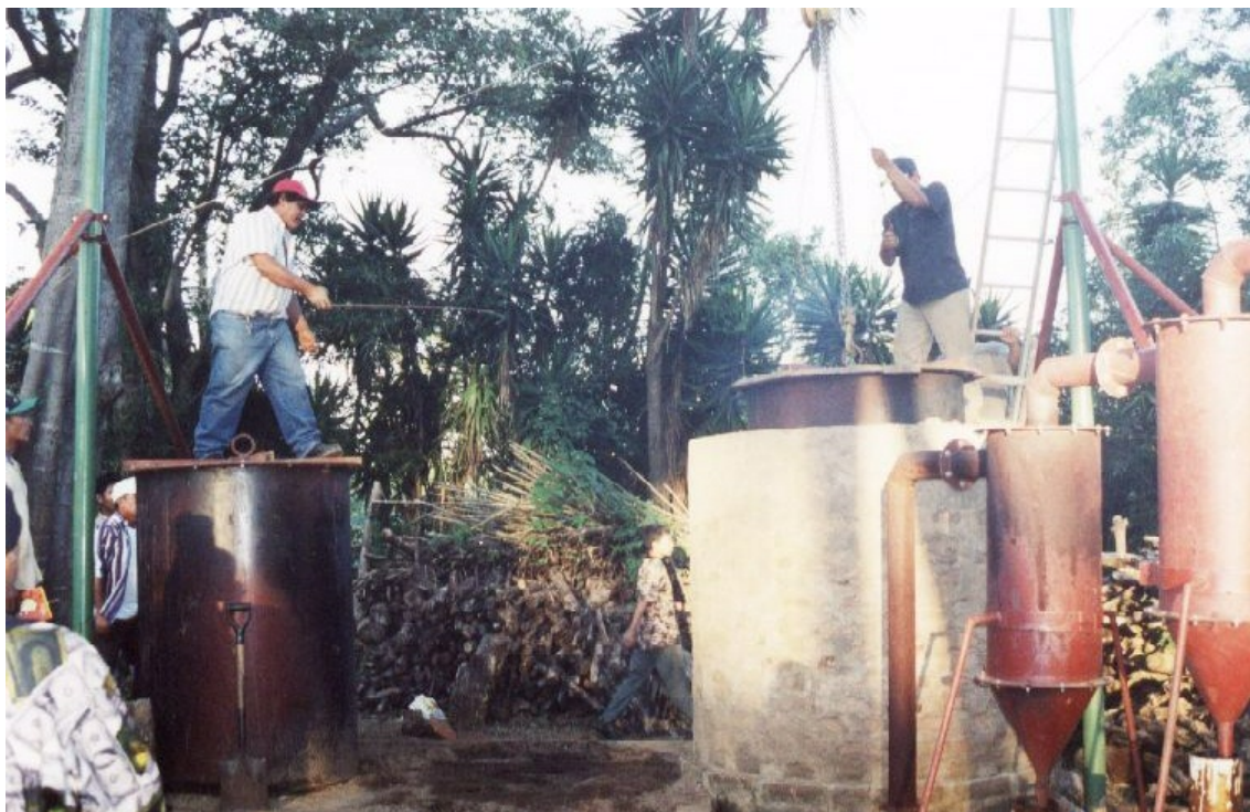
Figura 2 - Retirada do container após carbonização (cidade de Diriamba - Nicarágua)
