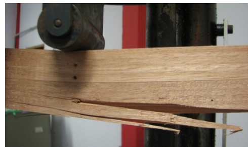
Viga Laminada Colada 2 - E_{m0} dinâmico: 17035 MPa - E_{m0} estático: 15809,33 MPa - f_M : 96,67 MPa
