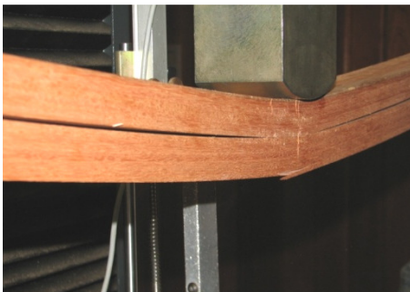
Viga não solidarizada 1
