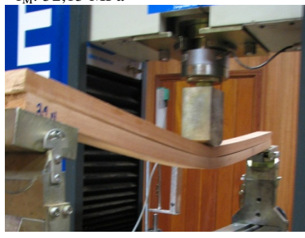
Viga não solidarizada 4
