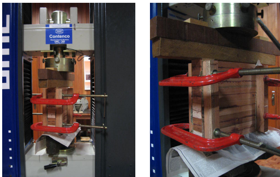
Figura 10 –Pilha de pares de barras coladas prensadas simultaneamente pela mesma pressão
