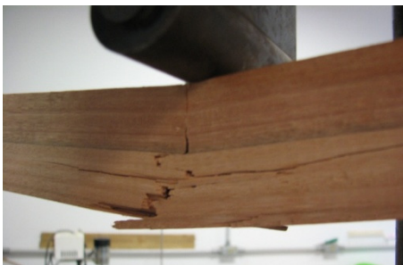
Viga Laminada Colada 1 - E_{m0} dinâmico: 19032 MPa - E_{m0} estático: 17719,00 MPa - f_M : 113,71 MPa
