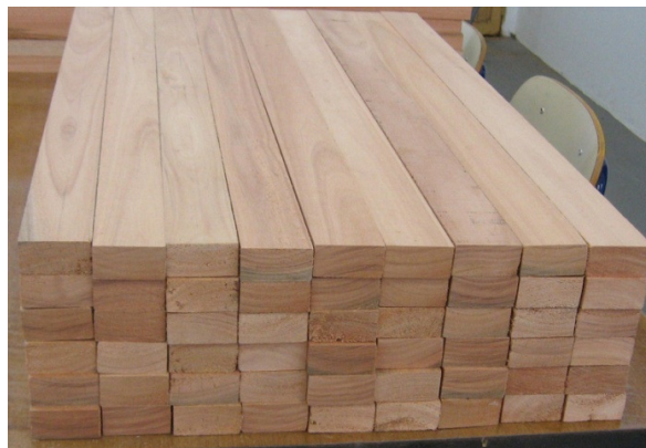
Figura 4 – Peças de Eucalyptus grandis usadas para o desenvolvimento dos ensaios
