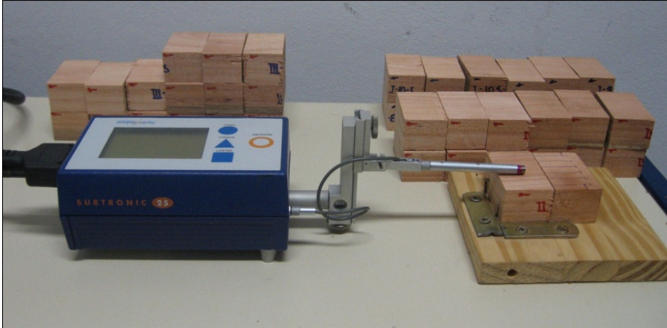
Figura 7 – Rugosímetro fazendo a leitura da rugosidade na superfície preparada de E. grandis
