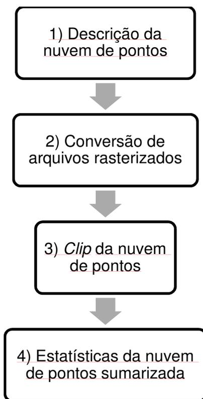
Figura 3 – Processamento dos dados LiDAR para obtenção da altura
