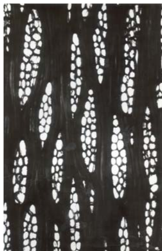
Figura 7 – Platonias insignis - corte tangencial onde se observam raios 2-3 seriados (faixas brancas fusiformes) e fibras (partes negras). Escala de 200 \mu m.
