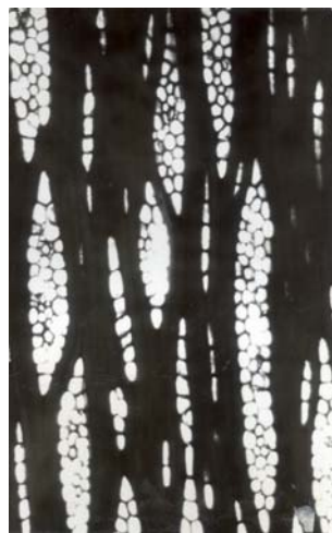
Figure 9 – Salvertia convallariodora - corte tangencial onde se observam raios 1-2 seriados (faixas brancas fusiformes) e fibras (partes negras com textura estriada). Escala de 200 \mu m.
