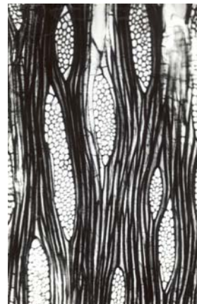
Figura 15 – Zeyhera tuberculata - corte tangencial mostrando raios multisseriados (faixas brancas largas) e fibras (partes negras com textura estriada). Escala de 200 \mu\text{m} .
