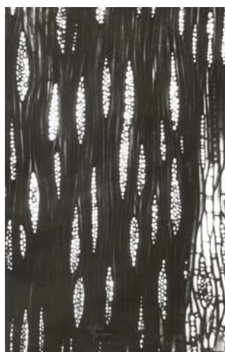
Figura 5 – Parkia platycephala - corte tangencial onde se notam raios 2-3 seriados (faixas brancas fusiformes) e fibras (áreas negras estriadas). Escala 200 \mu\text{m} .
