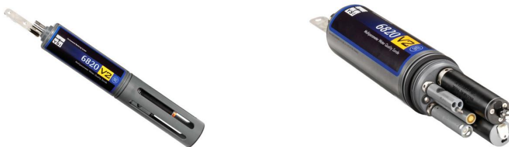
Figura 11. Sonda multiparâmetros modelo YSI 6820, utilizada nos trabalhos de campo.
