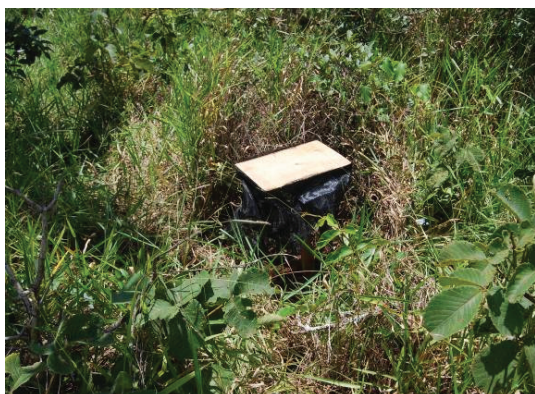
Figura 2.2 - Aparato de proteção em que foram instalados os termohigrômetros para evitar exposição direta da radiação solar. Instalado na borda do fragmento.
