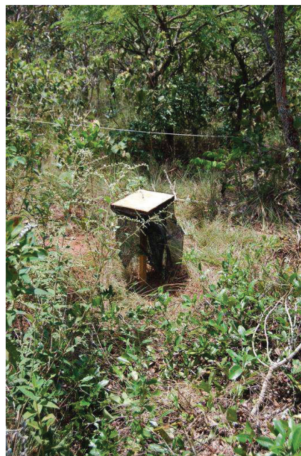
Figura 2.3 - Aparato de proteção em que foram instalados os termohigrômetros para evitar exposição direta da radiação solar. Instalado no interior do fragmento.
