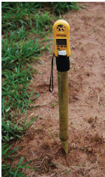
Figura 2.4 - Anemômetro instalado no suporte de 50 cm.
