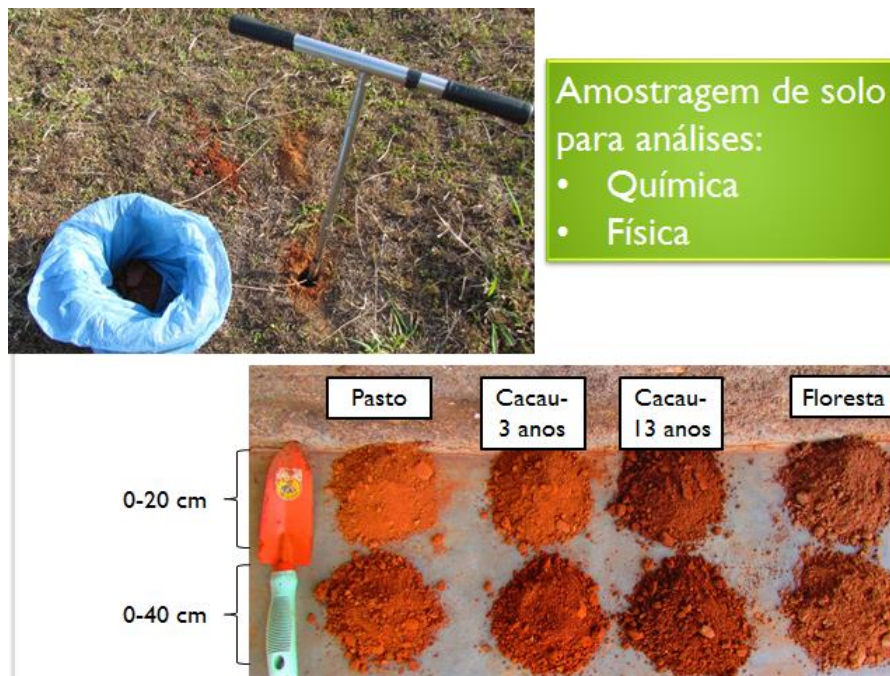
Figura 17 - Amostragem de solo utilizando saco plástico, trado holandês e balde. Diferenças da terra para cada uso do solo e em profundidade 0-20 e 20-40 cm
