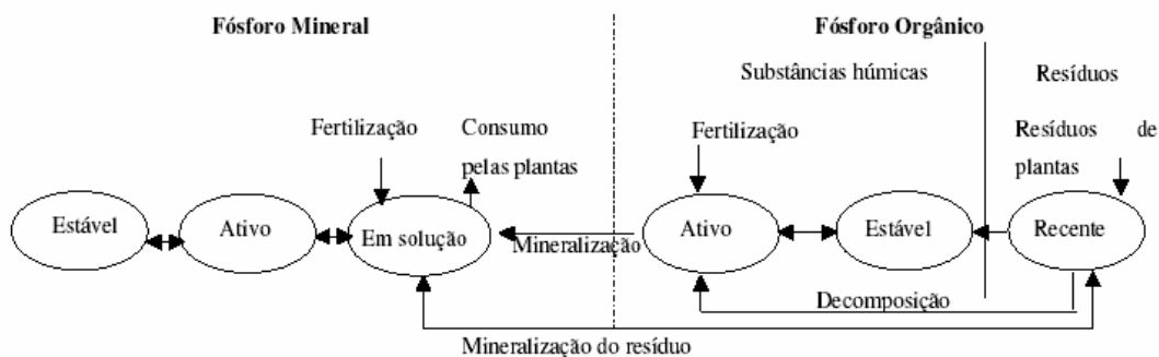
Figura 27. Formas e processos do Fósforo simulados pelo AVSWAT na fase terrestre Fonte: (modificado - NEITSCH et al. , 2002a).
