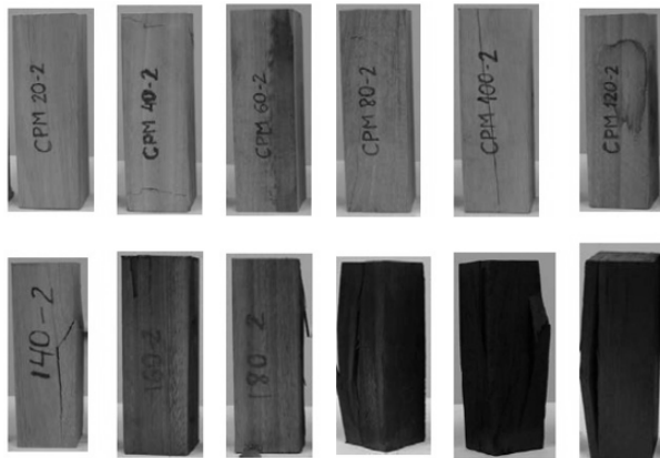
FIGURA 6: Variação na coloração da madeira e modos de ruptura após o ensaio de compressão.
