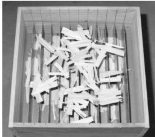
Figura 1. Sistema orientador de partículas e caixa formadora utilizados na formação do colchão.
