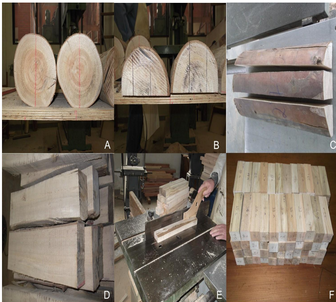
FIGURA 1.8 – PREPARAÇÃO DAS AMOSTRAS PARA A DETERMINAÇÃO DAS PROPRIEDADES FÍSICAS E MECÂNICAS
