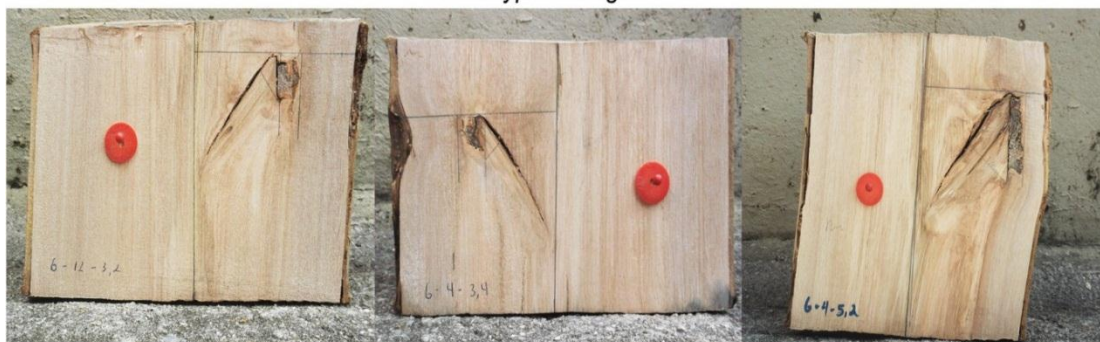
FIGURA 2.15 – CORTE LONGITUDINAL NAS SEÇÕES DO TRONCO DAS ÁRVORES DE DIFERENTES ESPÉCIES DE Eucalyptus , COM A OCLUSÃO DO NÓ FONTE: O autor (2014)
