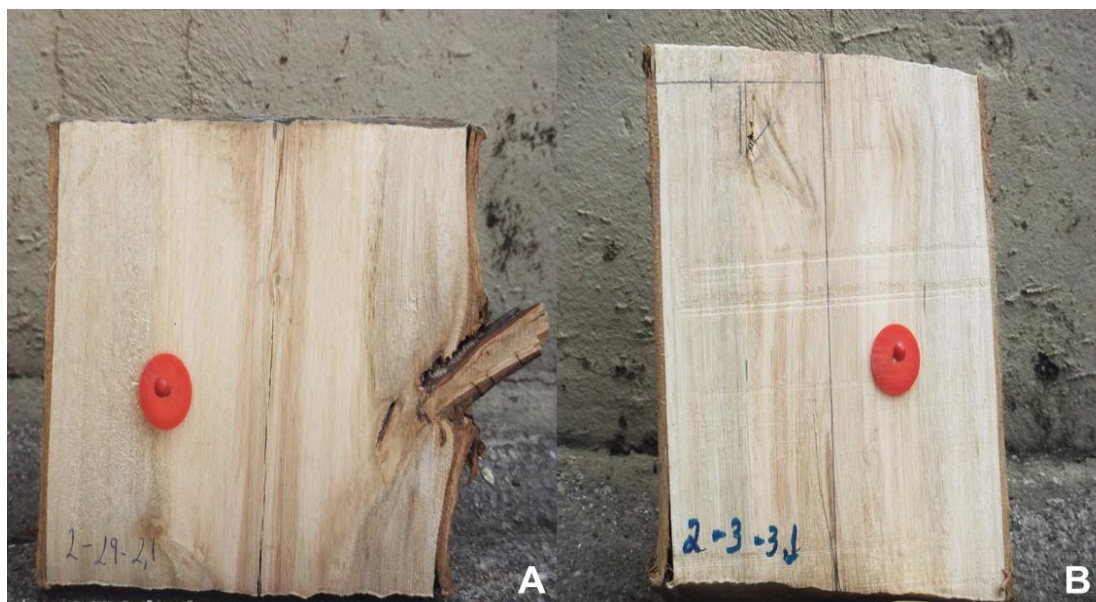
FIGURA 2.10 – COMPORTAMENTO INTERNO DA ÁRVORE PODADA
