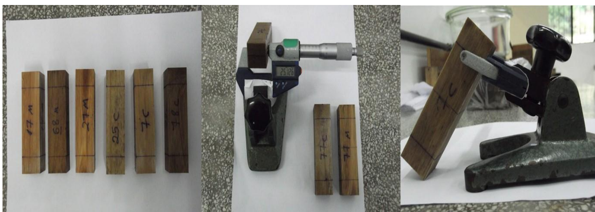
FIGURA 1.9 – MENSURAÇÃO DOS CORPOS DE PROVA PARA DETERMINAÇÃO DA CONTRAÇÃO DIMENSIONAL DA MADEIRA
