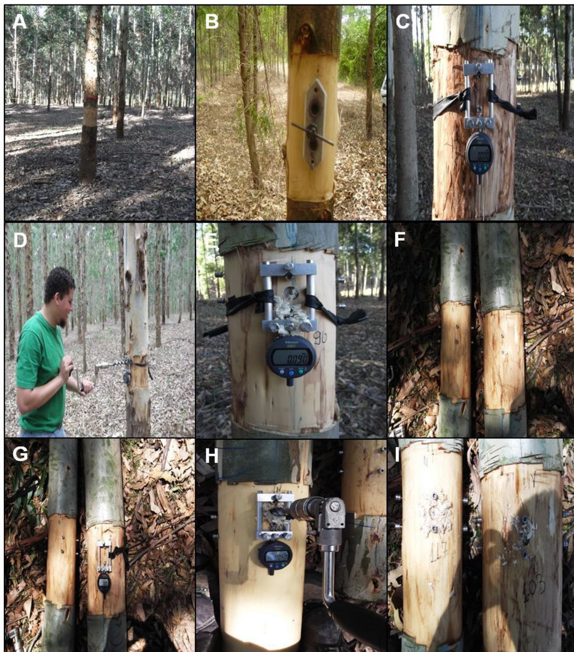
FIGURA 1.6 – MEDIÇÃO DA DEFORMAÇÃO RESIDUAL LONGITUDINAL
