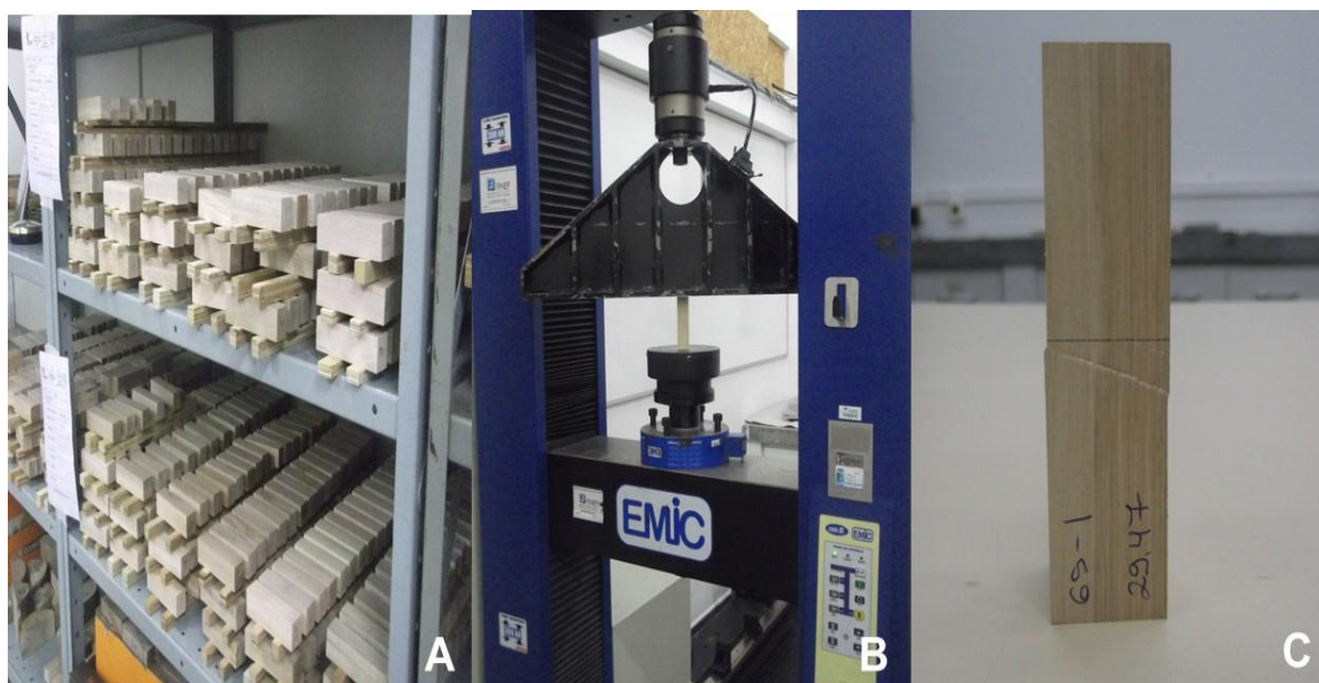
FIGURA 1.10 – ETAPAS DA DETERMINAÇÃO DA COMPRESSÃO PARALELA AS FIBRAS
