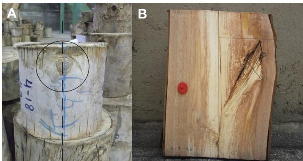
FIGURA 2.8 – CORTE NO SENTIDO LONGITUDINAL DOS TOCOS PARA ANÁLISE DA PODA NAS DIFERENTES ESPÉCIES DE Eucalyptus
