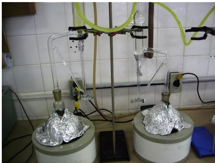
Figura 1 - Aparelho Clevenger utilizado para a extração do óleo essencial de C.sylvestris
