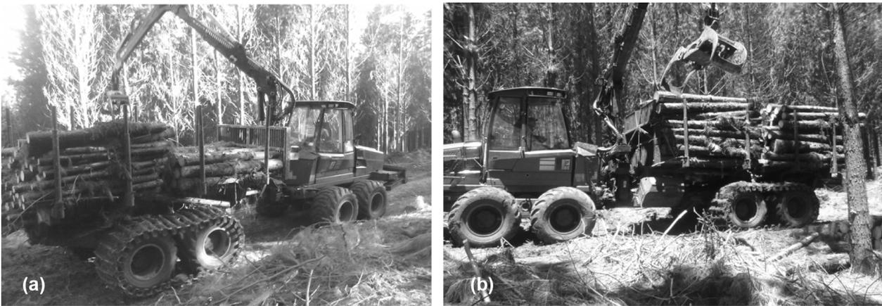
**Figura 1.** Extração de madeira com *forwarder* nos modelos operacionais de extração 1(a) e 2 (b).
