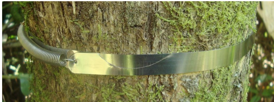
Figura 3. Faixa dendrométrica de aço inoxidável, com precisão na leitura de 0,2 mm, instalada no tronco de um dos indivíduos estudados .
