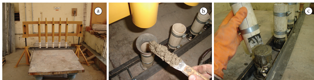
Figura 2. Sistema alternativo de moldagem por vibrocompressão: a) composição do sistema; b) preenchimento dos corpos de prova cilíndricos; c) acabamento da superfície dos corpos de prova.
