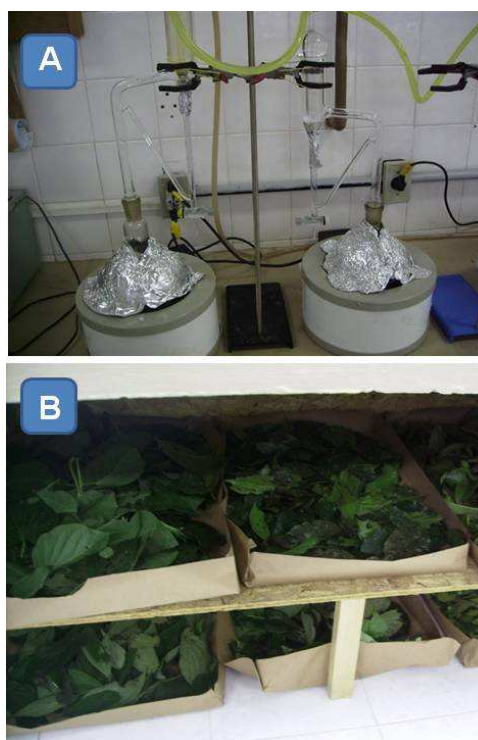
FIGURA 3 – A) – Aparelho Clevenger utilizado para hidrodestilação; B) – Material selecionado para hidrodestilação. Curitiba, 2010
