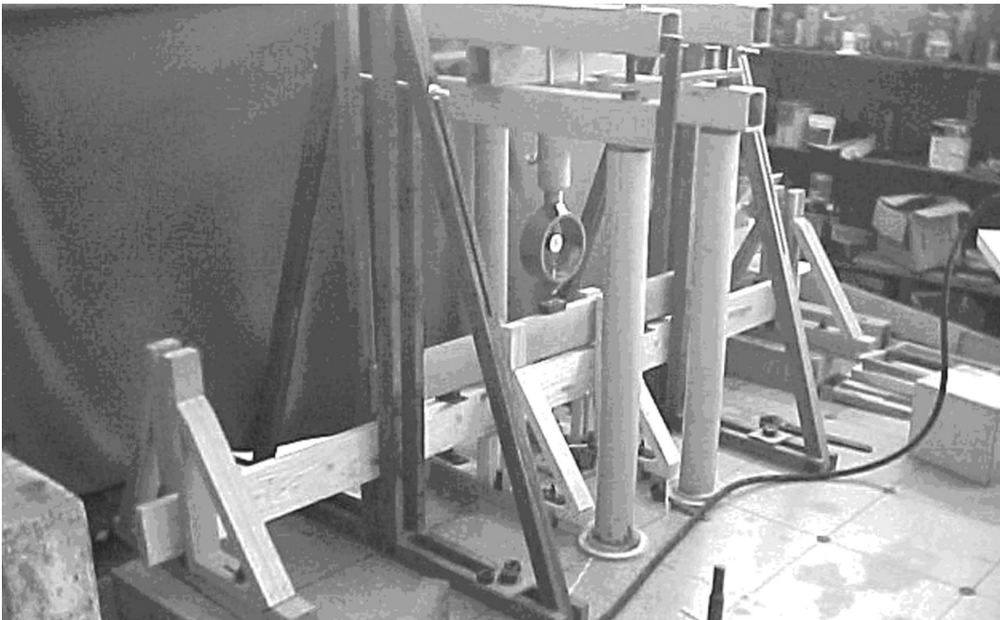
Figura 7 Detalhe dos contraventamentos. (Bracing detail)
