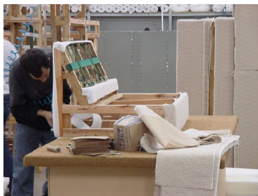
COLOCAÇÃO DAS PERCINTAS
