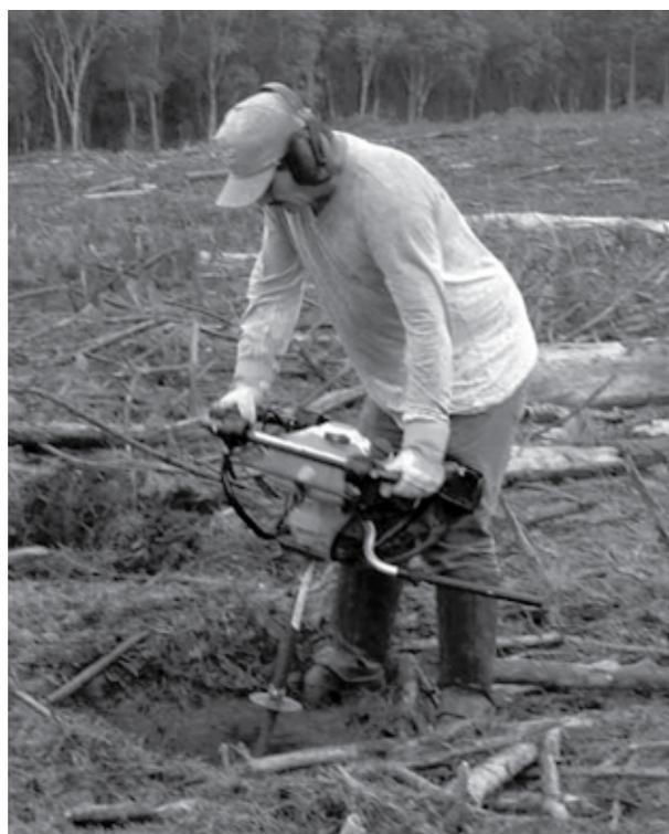
**Figura 1.** Perfurador de solo em operação
