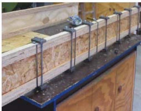
Figura 1. Prensagem e amarração das vigas “I”.
