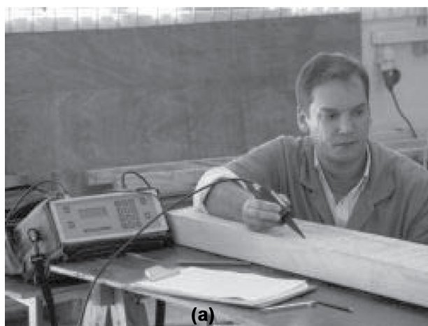
Figura 1. Testes para classificação mecânica da madeira de parica: (a) ultrassom e (b) teor de umidade. Figure 1. Tests for mechanical parica timber classification: (a) ultra-sound and (b) moisture content.
