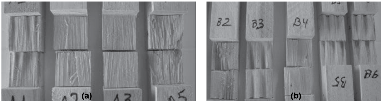
Figura 7. Modos de ruptura característicos das linhas de cola após ensaio de cisalhamento: (a) adesivo RS 216-M e (b) adesivo EPI EL-70.
