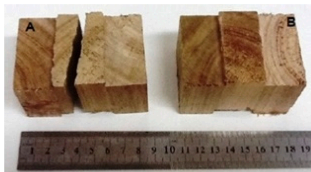
Figura 2. Corpos de prova do tipo 'H', rompidos na madeira e intactos.
