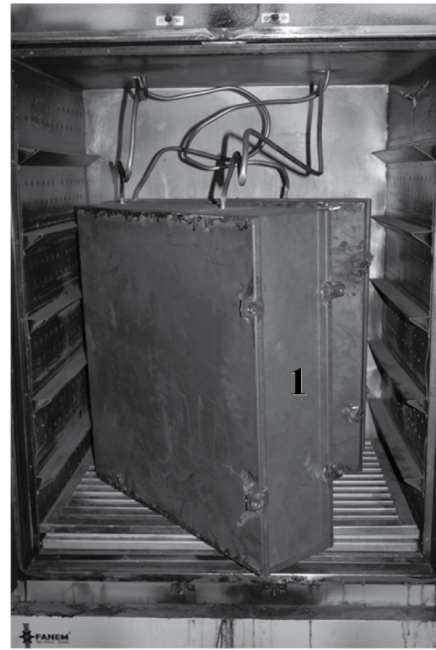
Figura 1. Projeto das caixas para instalação no interior da estufa, visando injeção de nitrogênio gasoso: A) Tubulação à direita para entrada do gás (1), trocador de calor (2), tubulação à esquerda para a saída do gás (3); B) Visão geral do sistema instalado na estufa, indicando a abertura unilateral (1).
