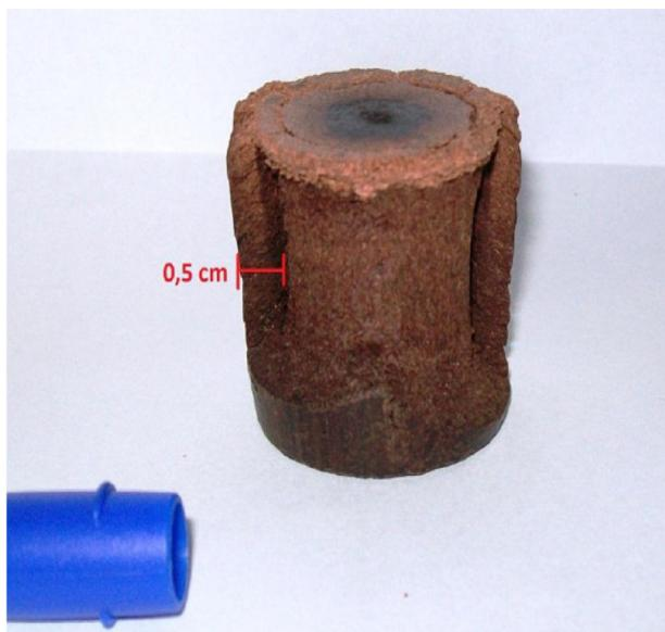
**Figura 5.** Briquete fraturado durante processo de compactação e resfriamento, mostrando duas regiões de consistência diferenciadas e concêntricas.
