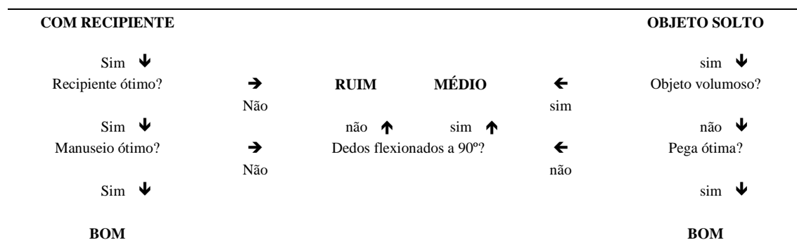
Figura 1. Fluxo de decisão para o tipo de encaixe das mãos na carga.
