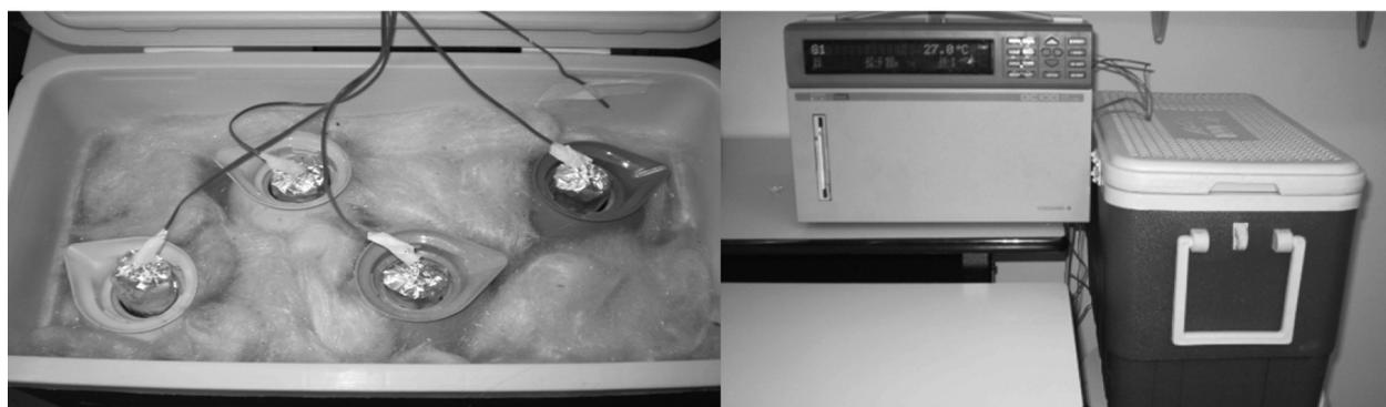
**Figura 1.** Sistema utilizado na análise de aptidão da mistura cimento-madeira.
