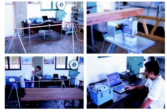
Figure 1 – Nondestructive testing by transverse vibration.Figura 1 – Avaliação não destrutiva por meio da vibração transversal.
